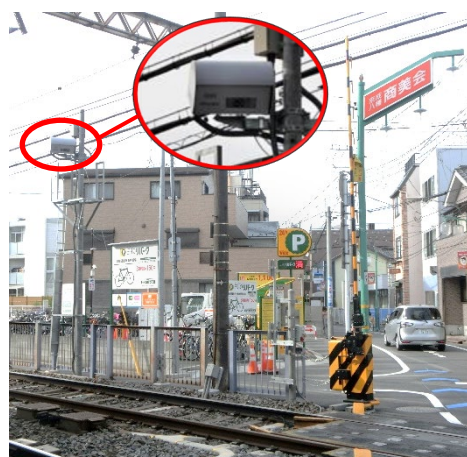
3次元レーザレーダ式自動障害物検知装置
